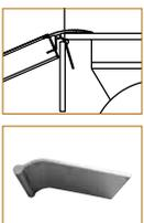
**Linguetta in alluminio (standard):** questo sistema di ancoraggio ha il vantaggio che la linguetta può traslare su buona parte della larghezza della rampa e ruotare nella testata dove è stata precedentemente inserita. Sono forniti appositi tappi di chiusura testata affinché la linguetta non esca dalla rampa durante il suo utilizzo.
