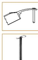
**Perno in acciaio (su richiesta):** attraverso i fori della testata standard della rampa e del piano di carico può essere inserito un perno in acciaio zincato del diametro di 14 mm e testa avente diametro di 24 mm.
