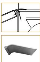
**Linguetta in alluminio (standard):** questo sistema di ancoraggio ha il vantaggio che la linguetta può traslare su buona parte della larghezza della pedana e ruotare nella testata dove è stata precedentemente inserita. Sono forniti appositi tappi di chiusura testata affinché la linguetta non esca dalla pedana durante il suo utilizzo.
