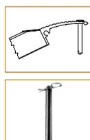
**Perno in acciaio (su richiesta):** attraverso i fori della testata standard della pedana e del piano di carico può essere inserito un perno in acciaio zincato del diametro di 14 mm e testa avente diametro di 24 mm.
