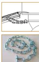
**Grillo con catena in acciaio (standard):** la catena in acciaio deve essere agganciata al piano di carico tramite il grillo in dotazione e deve essere infilata sotto il piano di calpestio della rampa negli appositi e predisposti sistemi di aggancio della stessa.
