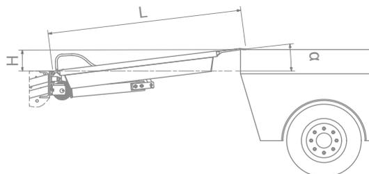
Per dislivello (H) si intende l'altezza del piano di carico dal fulcro del ponte o della sponda.
