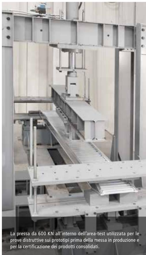
La pressa da 600 KN all'interno dell'area-test utilizzata per le prove distruttive sui prototipi prima della messa in produzione e per la certificazione dei prodotti consolidati.
