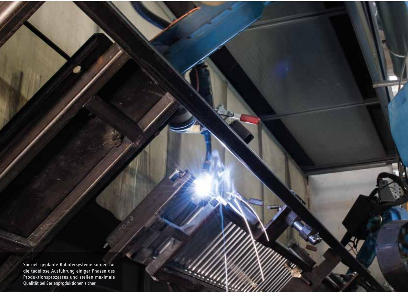
Speziell geplante Robotersysteme sorgen für die tadellose Ausführung einiger Phasen des Produktionsprozesses und stellen maximale Qualität bei Serienproduktionen sicher.
