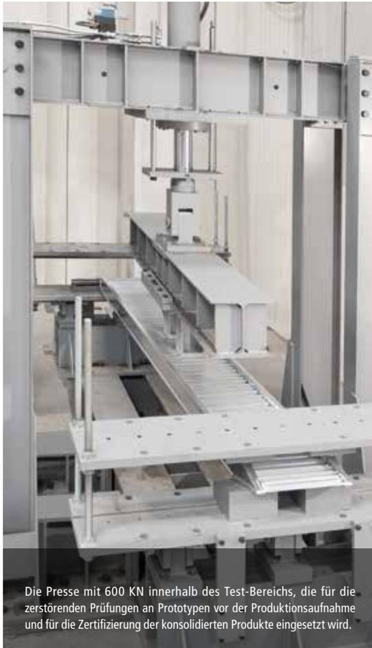
Die Presse mit 600 KN innerhalb des Test-Bereichs, die für die zerstörenden Prüfungen an Prototypen vor der Produktionsaufnahme und für die Zertifizierung der konsolidierten Produkte eingesetzt wird.
